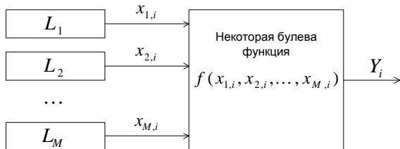
Рис. 4.3. Генератор с несколькими регистрами сдвига.
